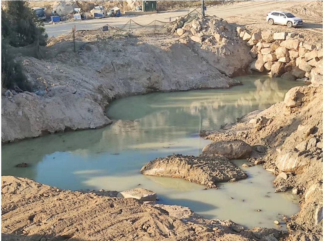
采区沉淀池（蓄水池）
