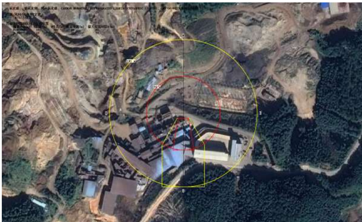
图 5-13 煤气管道泄漏超过阈值最大轮廓线
